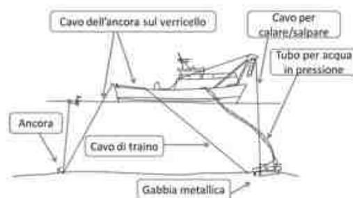
Figg.5,6 - Schemi del sistema di pesca con draga idraulica
