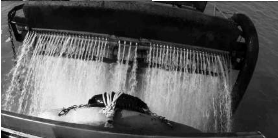
Figura 48. Draga idraulica. In basso dettaglio dei getti di acqua in azione.
