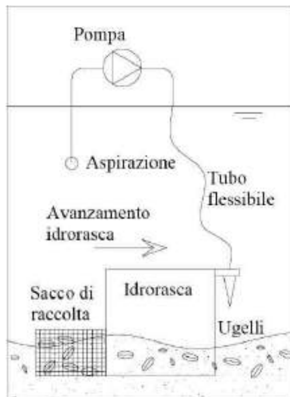
Figura 30. Schema idraulico di funzionamento di una idrorasca con relativa motopompa associata (fonte: Provincia di Ferrara, 2007).
